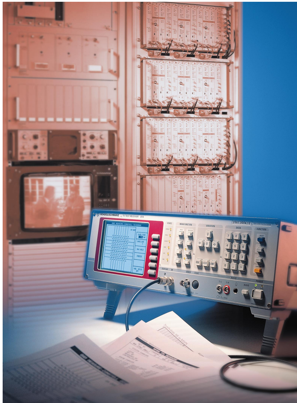
BILD 1 TV-Meßempfänger EFA, ein flexibler Spezialist für Messungen an analogen wie digitalen TV-Signalen – hier im Einsatz in einer Kabelkopfstelle. Foto 42 575
