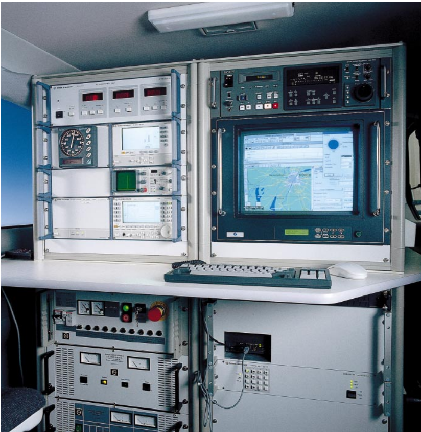
BILD 2 Der Peilzusatz DDF190 erweitert einen VHF-UHF-Empfänger zu einem hochwertigen Peilsystem – unübertroffen in der Kompaktgeräteklasse bezüglich Genauigkeit und Empfindlichkeit bei Frequenzen oberhalb 1 GHz.
