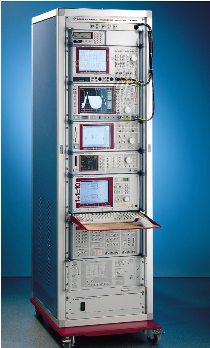
BILD 1 Fahrbare Ausführung des Fernsehsender-Meßsystems TS6140 für umfangreiche Messungen an Bild und Ton außerhalb der Programmzeiten. Foto 42 486
