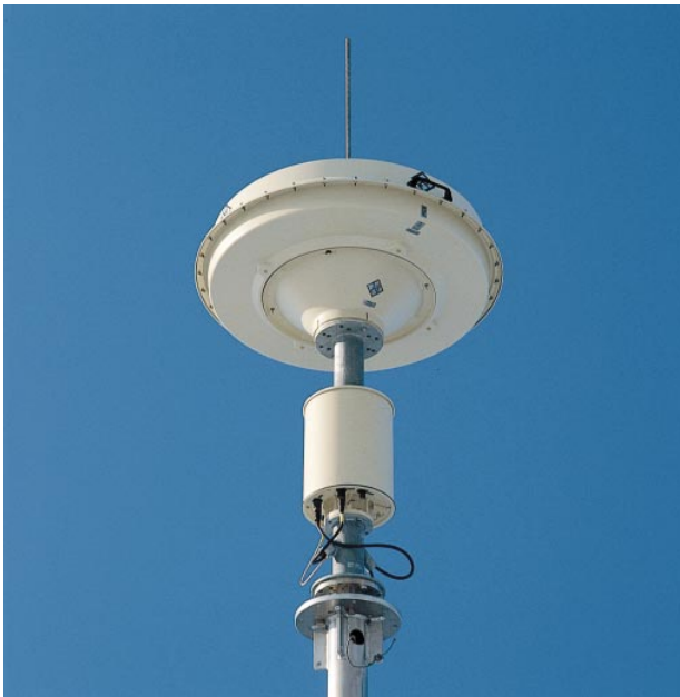
BILD 4 Antennen ADD190 (oben) und ADD071 am gemein- samen Tragmast. Foto 42 477/1
